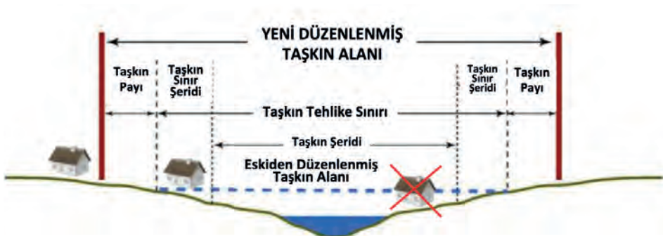
Şekil 8.22. Eski taşkın yataklarının değişen yağış rejimine göre nasıl yeniden düzenlenmesini gerektiğinin şematik bir gösterimi.
