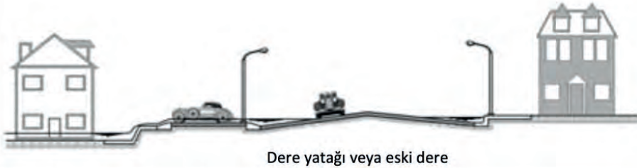
Şekil 3.2. Kentlerimizde yaygın olan derelerin üstü kapatılıp cadde ve sokağa çevrilmesinin şematik bir gösterimi (Andjelkovic, 2001).
