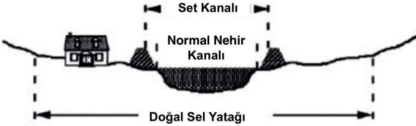
Şekil Ek-3.4.1. Doğal sel yatağındaki can ve mal kaybını önlemek için taşkın kontrol yapılarından biri olan setlerle akarsuyun etrafına zarar vermeyecek şekilde genişletilmesinin şematik bir gösterimi.
