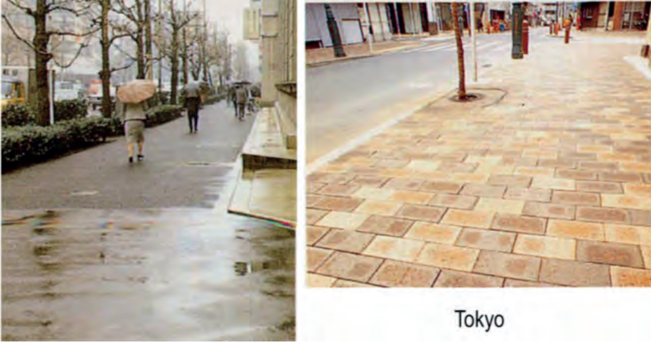
Şekil 8.10. Japonya’dan su geçiren asfalt ve kaldırım malzemesine bir örnek (Ikeuchi, 2012).
