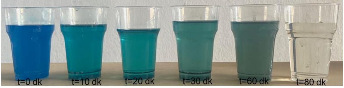
Opak siyah rengine sahip atıksuyun pilot ölçekli tesiste arıtılması: Tesiste yaklaşık 2.263 olan renk (Platin kobalt) 11'e düşürülmüştür.
