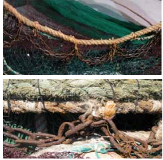
Şekil 1: Dip trol ağının alt zemin yakasını oluşturan çelik halat, kurşun yaka olarak da adlandırılmaktadır (Zengin vd, 2014a).
