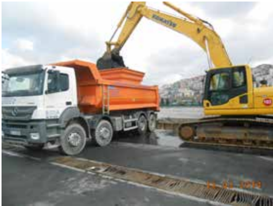
Sızdırmaz Bacalı Çamur Taşıma Kamyonu
