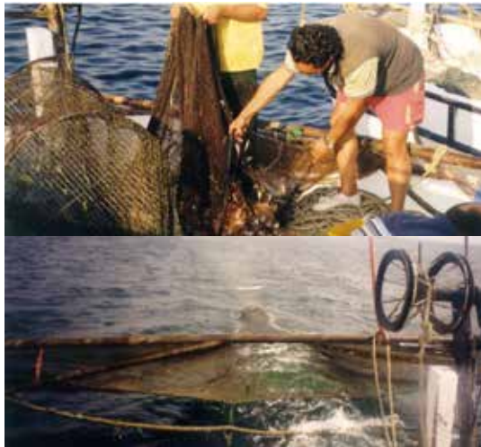
Şekil 6: İzgara-panelli kaçış penceresini içeren modifiye algarna ağ ile gerçekleştirilen deneysel çalışmalar, Gemlik kıyıları (Zengin vd, 2004).
