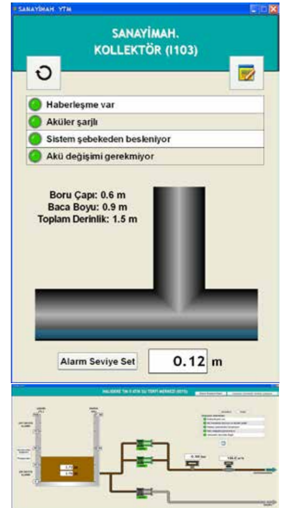
Şekil 2. Atıksu pompa istasyonu kontrol ve izleme paneli
